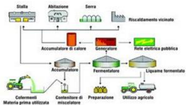
Imm.37: funzionamento impianto a biogas
